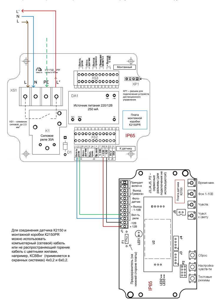
Вариант 2. Непосредственное подключение светильников к монтажной коробке K2150PR
